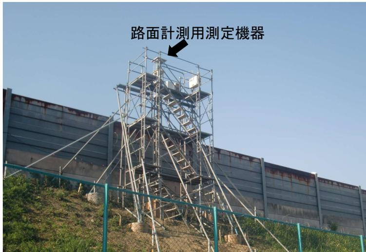
路面計測用測定機器
