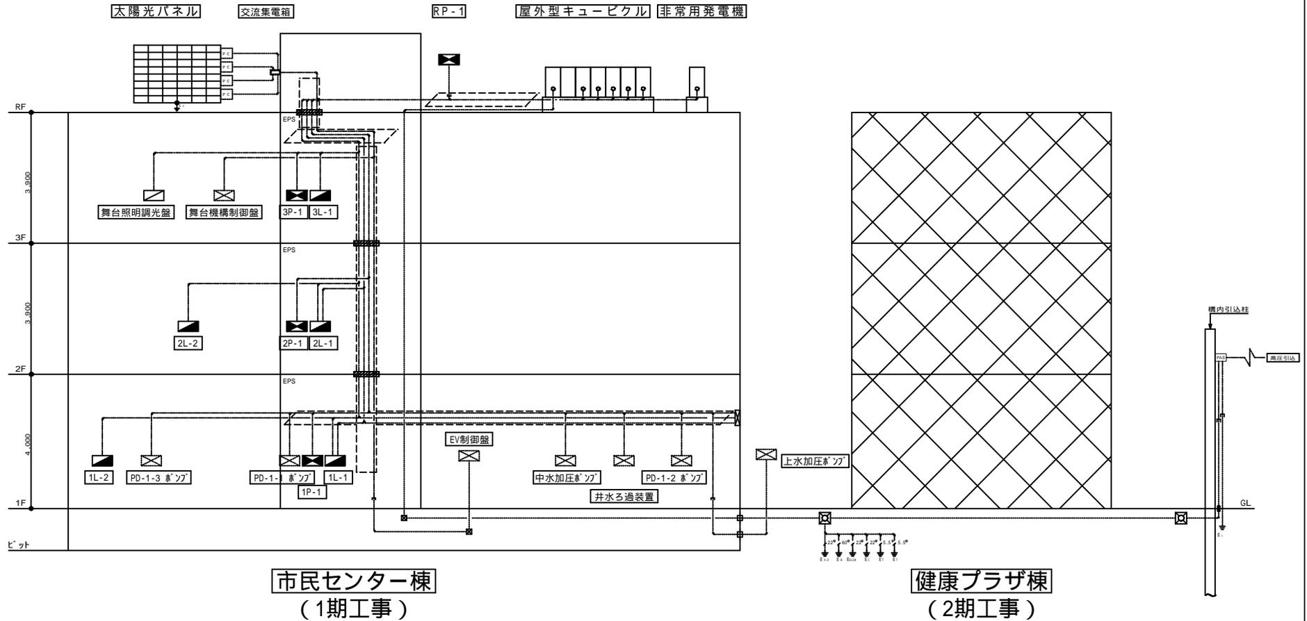
電気設備幹線系統図
