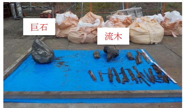
確認された支障物
