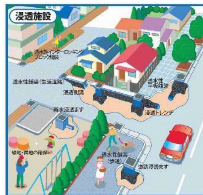
雨水浸透施設のイメージ（公益社団法人雨水貯留浸透技術協会資料）
