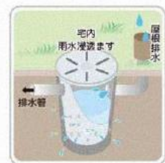
宅内雨水浸透ます
